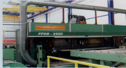
4. Peddinghaus FPDB plaka işleyici sistemi tüm plaka bileşenlerinin tarama zımbalama/delme/işaretleme/ ve termal kesimi
