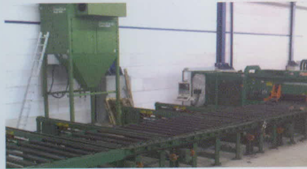
3. Entegre plaka malzeme taşıma ile bir FPDB plaka işleyicisi
